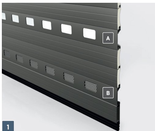
1 Tablier de porte – réalisé en lames en aluminium d'une hauteur de 100 mm et d' une épaisseur de 25 mm remplies de mousse en polyuréthane sans fréon. (A) – lame à double paroi vitrée en aluminium, (B) – lame à double paroi ventilée en aluminium.
