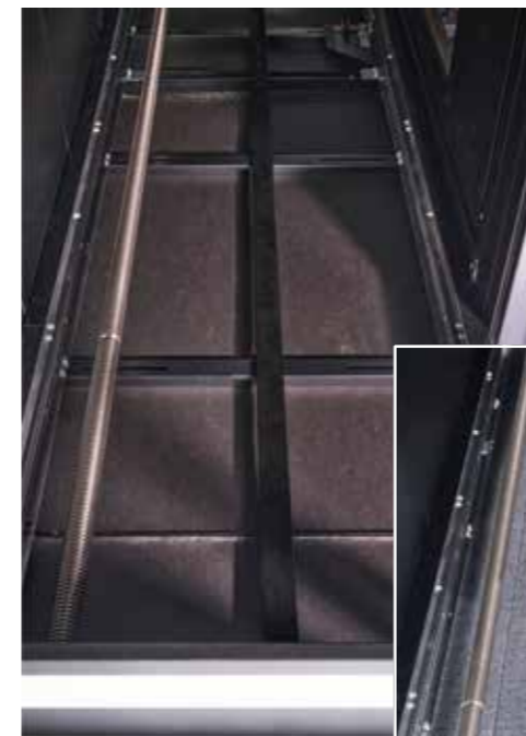
Placage latéral de la machinerie avec natte fine noire
